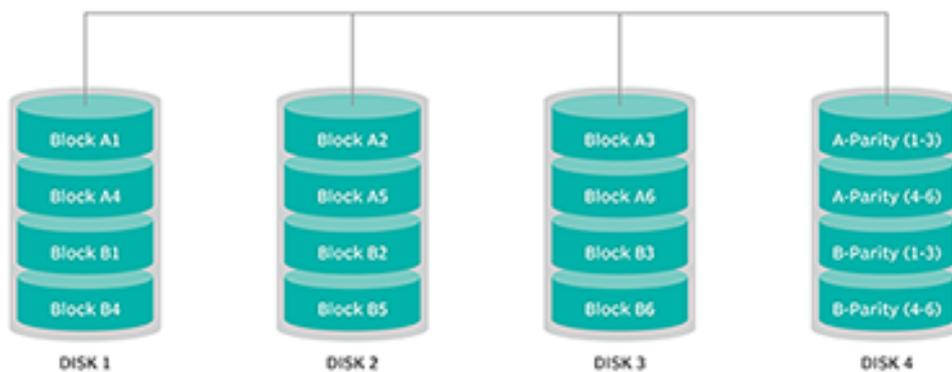
Un RAID 5 est une technologie constituée de minimum 3 disques contenant des données et dans lequel chaque disque contient une parité de tous les disques c'est à dire une version condensée de tous les disques.
